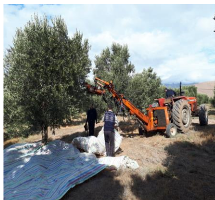
شکل ۲- تکاننده تنه در حال برداشت زیتون
