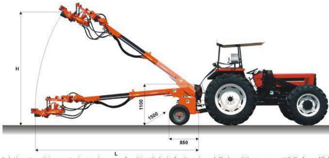
شکل ۱- طرح‌واره تکاننده تنه، سوار بر اتصال سه نقطه تراکتور
