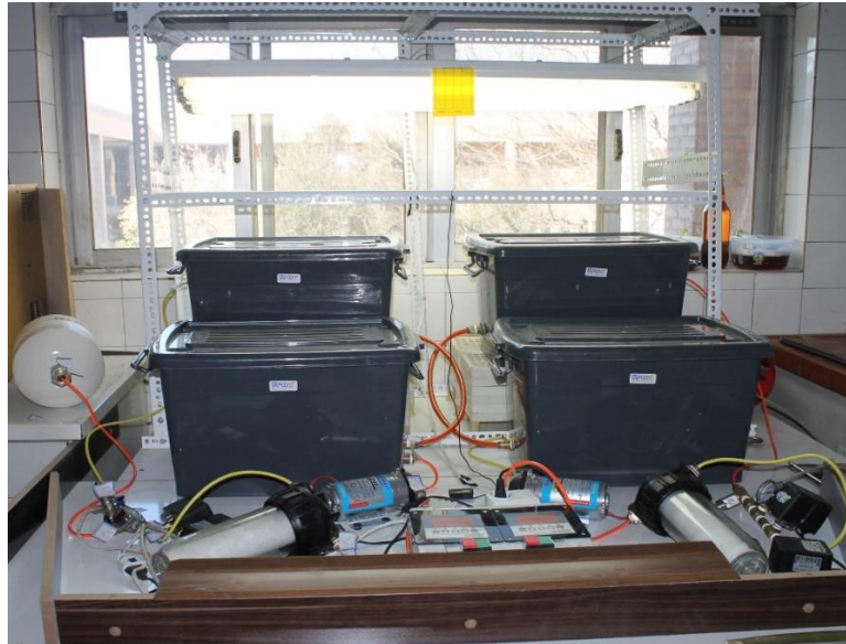
شکل ۲- سامانه افقی آب/هواکشت
