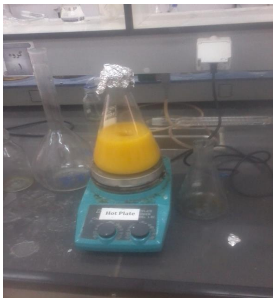
شکل ۴- ترکیب روغن و متانول در حضور کاتالیزور
