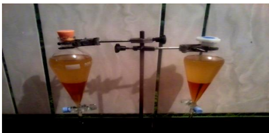
شکل ۵- جداسازی بیودیزل (قسمت بالا) و گلیسرول Fig 5. Separation of biodiesel (top layer) and glycerol
