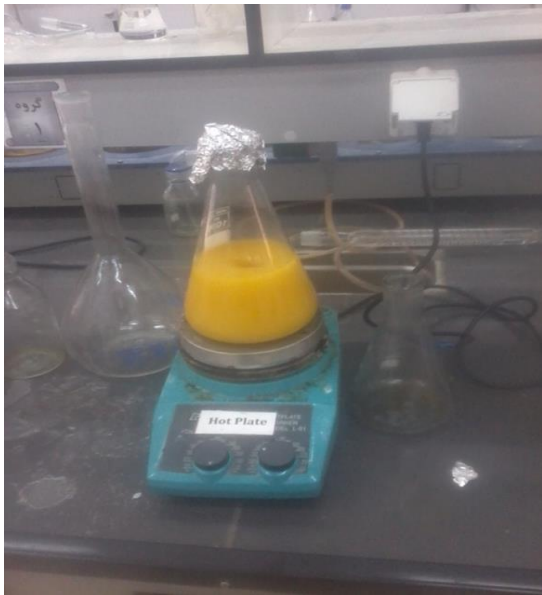
شکل ۴- ترکیب روغن و متانول در حضور کاتالیزور Fig 4. Mixing of oil and methanol in the presence of a catalyst
