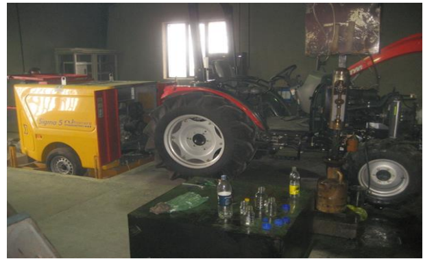
شکل ۶- دینامومتر متصل به تراکتور جهت اندازه‌گیری پارامترهای مورد مطالعه
