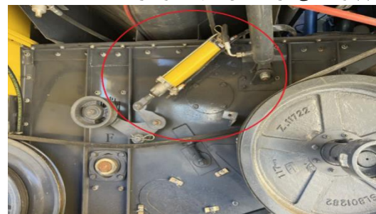
شکل ۴- محرک جک بادی واحد کوبنده Fig 4. Air jack actuator of the impactor unit
