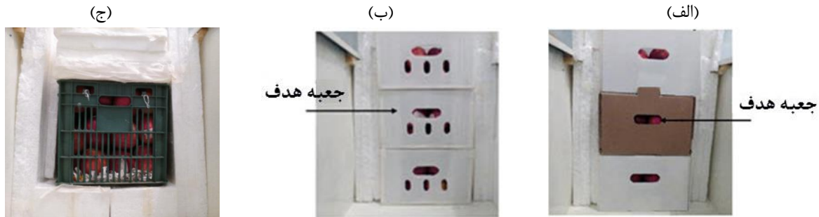
شکل ۳- موقعیت قرارگیری جعبه‌ها در داخل تونل باد افقی: (الف) جعبه کارتن پلاست رایج، (ب) جعبه کارتن پلاست طرح جدید، (ج) جعبه پلی اتیلن
