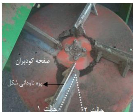
شکل ۲- نحوه قرار گرفتن پره‌های کودپران در حالت بسته (وضعیت ۱) و حالت باز (وضعیت ۲)
