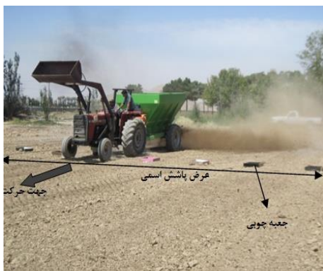
شکل ۳- نحوه قرار دادن جعبه‌ها در مسیر کودپاشی
