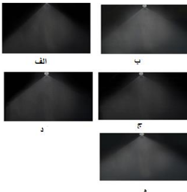
شکل ۱۲- تصاویر پاشش در فرکانس ۷ هرتز و فشار کاری ۲ بار برای (الف) DC=۲۰٪ (ب) DC=۳۰٪ (ج) DC=۵۰٪ (د) DC=۷۰٪ (ه) DC=۹۰٪
