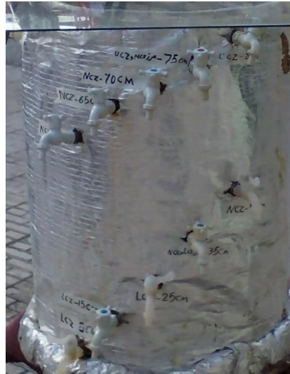
شکل ۴- نحوه قرار گرفتن شیرها را بر روی بدنه استخر
