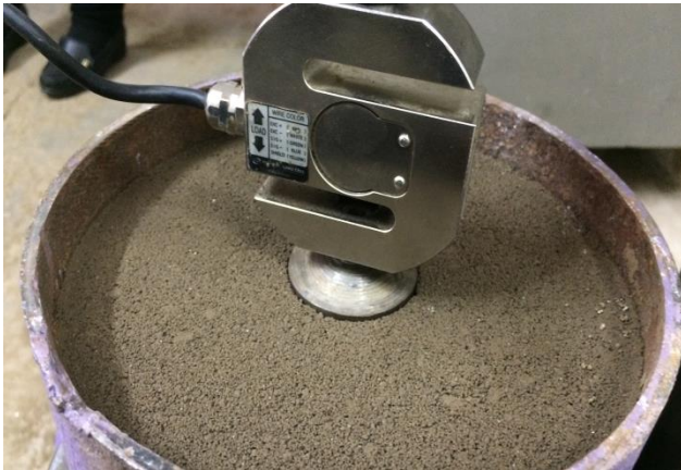
شکل ۱- ظرف آزمایش و سامانه بارگذاری در آزمون نشست صفحه‌ای
