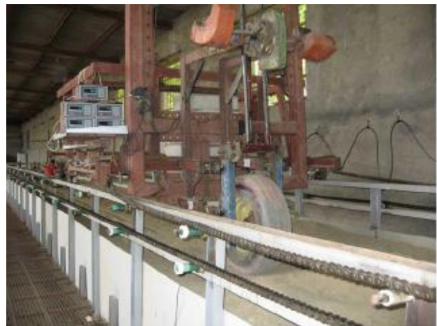
شکل (۳): انباره خاک و آزمونگر تک چرخ
