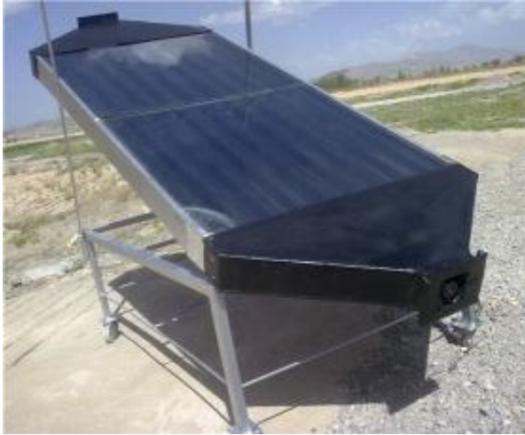
شکل (۱): جمع‌کننده ساخته شده به ابعاد ۱۵/۰×۱×۲ متر
