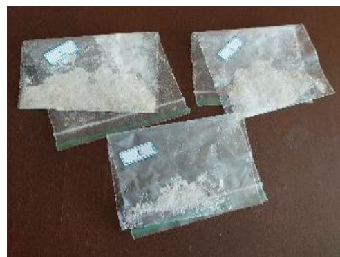
شکل ۲- پودر حاصل از روش اسپری درایر
