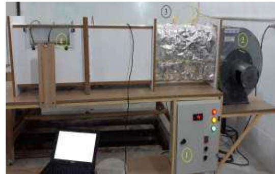
شکل ۱- نمای خشک کن هوای داغ همرفتی، ۱) واحد کنترل الکتریکی ۲) فن ۳) المنت‌های حرارتی ۴) سینی نمونه‌های میگو
