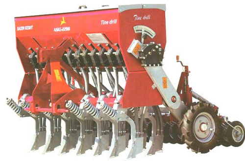
شکل ۱: -خطی کار (کشت مستقیم) دیم ASKE-2200 ساخت شرکت سازه کشت کاوه بوکان
