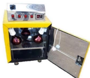
شکل ۱- خشک کن فرسوخ مورد استفاده در قسمت پیش تیمار
