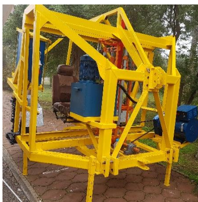
شکل ۳- ماشین الکتروهیدرولیک نفوذسنج مخروطی و نمونه‌بردار خاک کشاورزی
