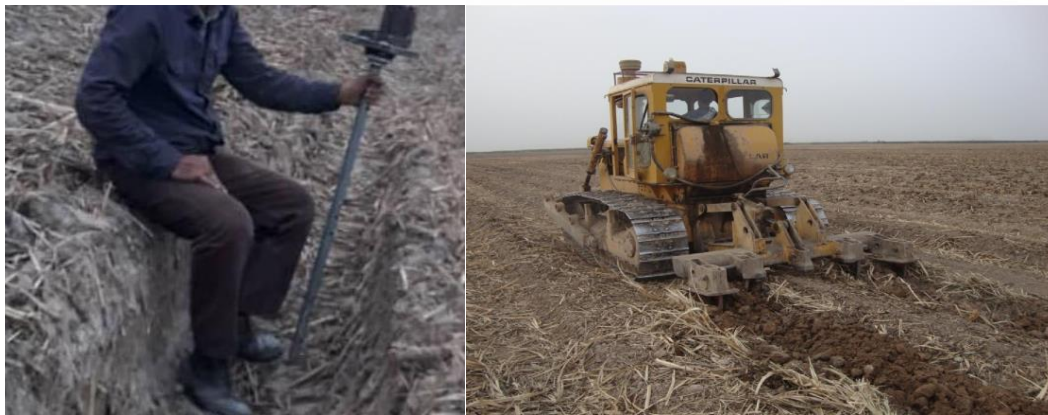
شکل ۱- عملیات بازرویی زیرشکن زنی با استفاده از ریپر بلدوزر (راست) فشردگی در مسیر جوی ناشی از تردد ماشین نیشکر (چپ) Fig 1. Compaction in the furrow after sugarcane harvester passes (left) Rationing operation by Bulldozer ripper (right)
