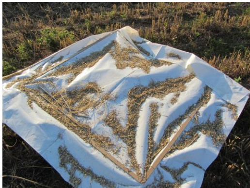
شکل ۴- قاب چوبی روکش‌دار استفاده شده در آزمون مزرعه‌ای برای اندازه‌گیری افت عقب کمباین Fig 4. Covered wooden frame used in the field test to measure the rear loss of the combine
