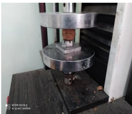
شکل ۲- آزمون بارگذاری فشاری گردو توسط دستگاه آزمون مواد و فک نگهدارنده گردو. Figure 2. Uniaxial compression loading test by universal testing machine.
