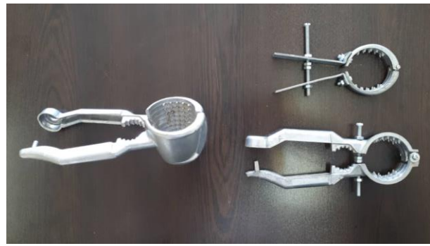
شکل ۳- وسیله محدود کننده تغییر شکل عرضی گردو و بارگذاری نمونه محصور شده.
