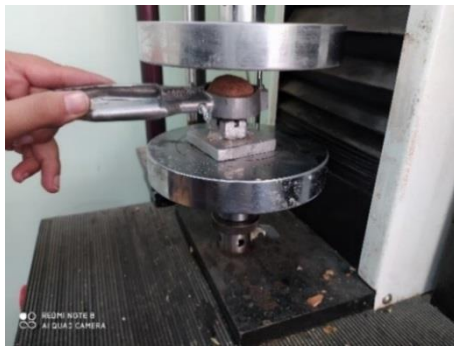
شکل ۳- وسیله محدود کننده تغییر شکل عرضی گردو و بارگذاری نمونه محصور شده.
