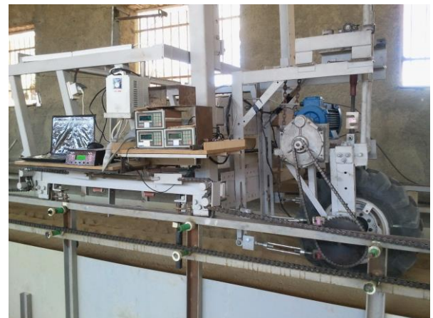
شکل ۲- آزمونگر تک چرخ مورد استفاده در تحقیق Fig 2. The used single wheel tester in the research
