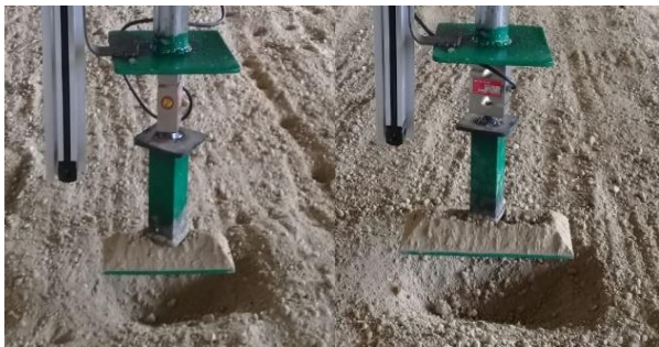
شکل ۴- آزمایش نفوذ صفحات برای تعیین ثابت‌های مدل بکر Fig 4. Pressure plates test for Bekker's equation
