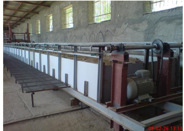
شکل ۱- مجموعه انباره خاک مورد استفاده در تحقیق Fig 1. The collection of soil bin used in the research
