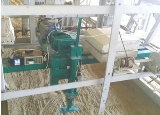
شکل ۳- سامانه بوامتر مورد استفاده در تحقیق Fig 3. The used Bevameter in the research
