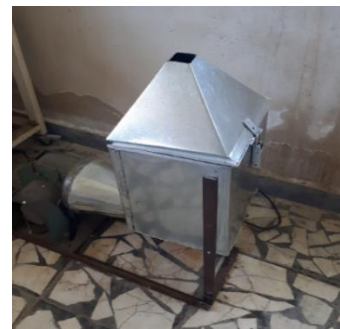
شکل ۴- دستگاه تست پایداری پلت Fig 4. Durability test device
