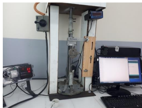
شکل ۲- دستگاه پلت ساز آزمایشگاهی Fig 2. Laboratory pelletizer device
