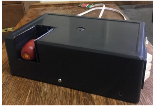
شکل ۵- سکوی الکترونیکی ساخته شده برای اندازه‌گیری خواص خازنی و پارامتر نیرو
