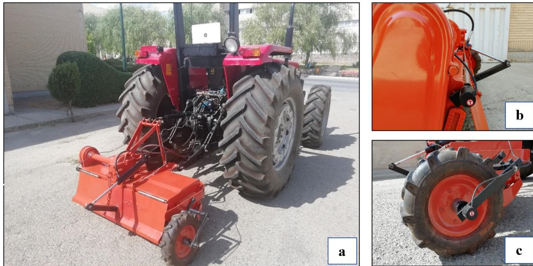
شکل ۱- سامانه الکترو-هیدرولیک کنترل موقعیت حفاظ روتیواتور. (a) ترکیب تراکتور-روتیواتور، (b) اینکودر نوری نصب شده روی لولای حفاظ خاک و (c) اینکودر نصب شده روی چرخ زمین‌گرد
