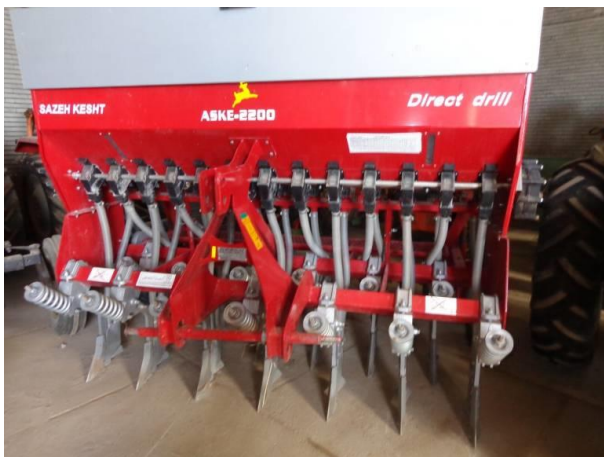
شکل ۳- کارنده کشت مستقیم مدل اسکی ۲۲۰۰ Fig 3. No-till planter model Aske 2200
