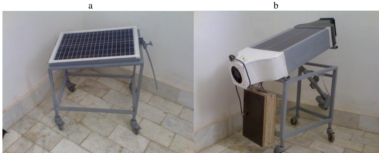
شکل ۳- (a) سیستم شاهد (b) گردآورنده حرارتی - فتوولتائیک
