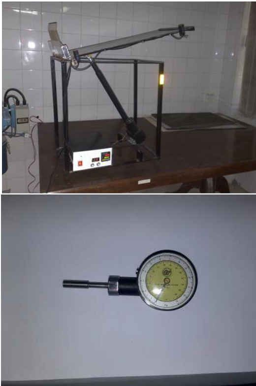
شکل ۱- دستگاه تعیین ضریب اصطکاک استاتیکی (بالا) و دستگاه نفوذسنج مورد استفاده (پایین)
