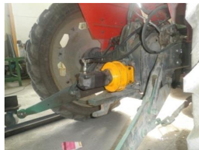
شکل ۴- نحوه اتصال مجموعه هیدروموتور و جعبه‌دنده خورشیدی به PTO تراکتور
