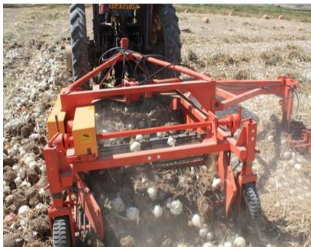
شکل ۳- پیازکن غربال دار و ردیف‌کن منضم به آن
