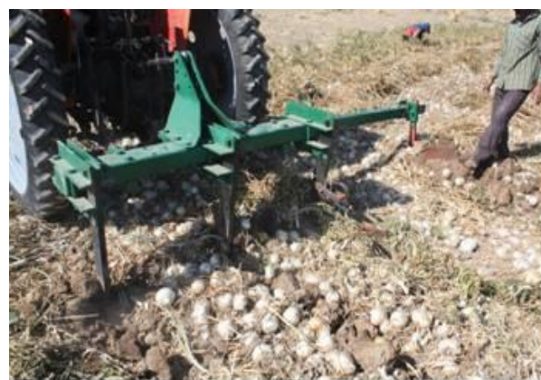
شکل ۲- پیازکن تیغه‌ای در حین عملیات کندن سوخ‌های پیاز
