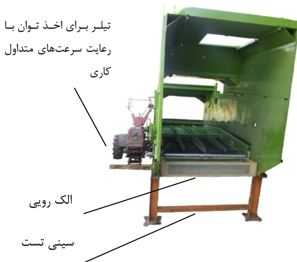
شکل (۲): طرحواره نمونه کارگاهی آزمایش تمیزکننده کمباین و نحوه جمع‌آوری محصول
