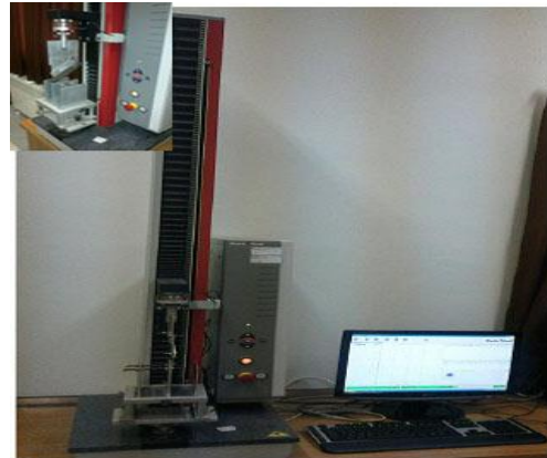
شکل (۱): دستگاه آزمون کشش- فشار به همراه فک برش
