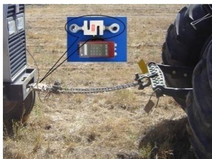
شکل (۴): اندازه‌گیری نیروی کششی به روش دو تراکتور
