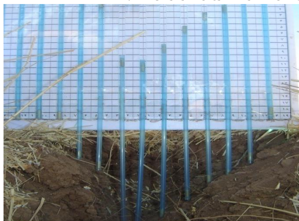
شکل (۳): پروفیل متر برای اندازه‌گیری پروفیل خاک به هم خورده
