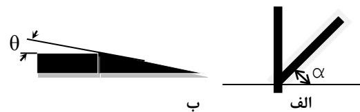
شکل ۲: نمایش (الف) زاویه استقرار ساقه و (ب) زاویه لبه تیغه نسبت به خط افقی
