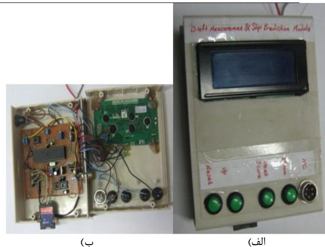
شکل (۳): الف و ب نمای بیرونی و داخلی کشش - لغزش سنج ساخته شده
