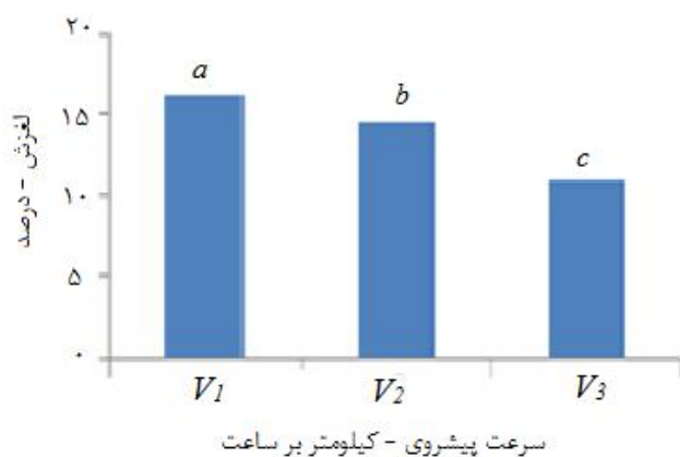
شکل (۸): اثر سرعت پیشروی روی لغزش چرخ‌های حرکت
