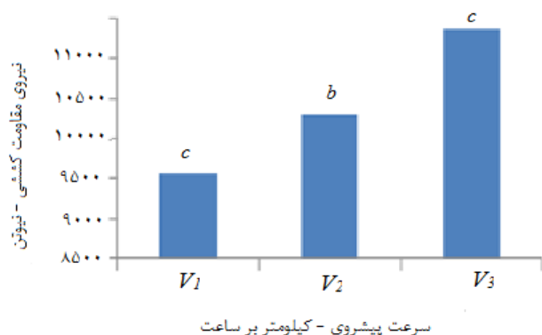
شکل ۶- مقایسه نیروی مقاومت کششی در سرعت‌های پیشروی مختلف
