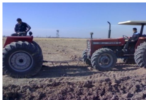
شکل (۵): نحوه اندازه‌گیری مقاومت غلتشی تراکتور بار
