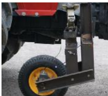
شکل 4- چرخ پنجم مورد استفاده در تحقیق به منظور اندازه‌گیری سرعت واقعی تراکتور
