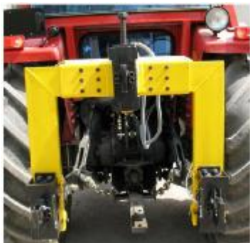
شکل 3- دینامومتر اتصال سه‌نقطه قابل تنظیم مورد استفاده در تحقیق.
